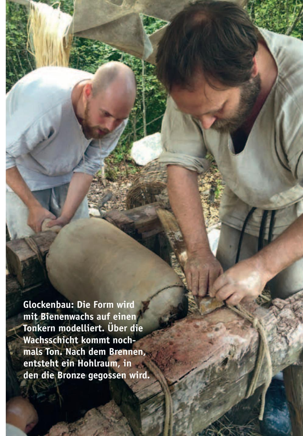
**Glockenbau: Die Form wird mit Bienenwachs auf einen Tonkern modelliert. Über die Wachsschicht kommt nochmals Ton. Nach dem Brennen, entsteht ein Hohlraum, in den die Bronze gegossen wird.**
